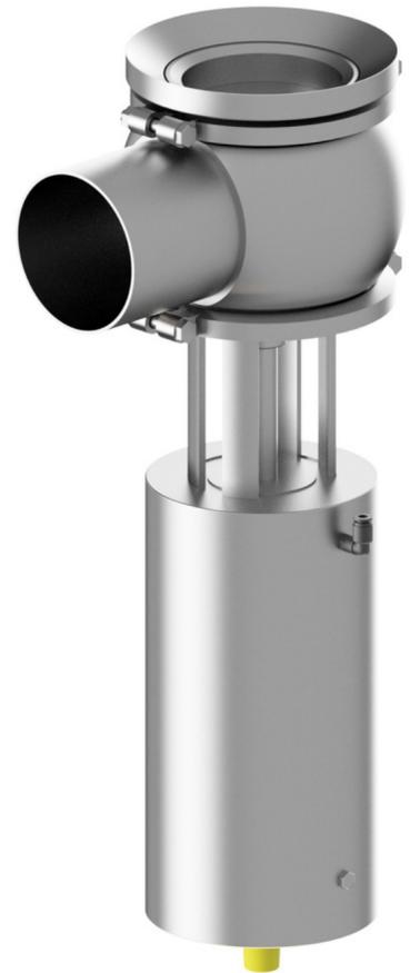
Es completamente higiénica con un pulido interior sanitario de una rugosidad Ra menor a 0,8µm. Todas las partes en contacto con el producto son fabricadas en Acero inoxidable AISI 316.
