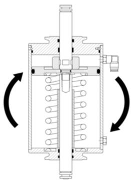
Posee un actuador rebatible para convertirla fácilmente de normal cerrada a normal abierta sin necesidad de desarmar el actuador neumático.
