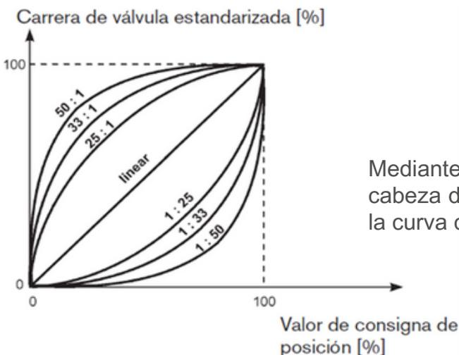
Mediante la programación de la cabeza de control se puede modificar la curva característica de la válvula.
