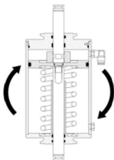
La VEH posee un actuador rebatible para convertirla fácilmente de normal cerrada a normal abierta sin necesidad de desarmar el actuador neumático.
