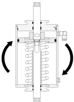
Posee un actuador rebatible para convertirla fácilmente de normal cerrada superior a normal cerrada inferior sin necesidad de desarmar el actuador neumático.
