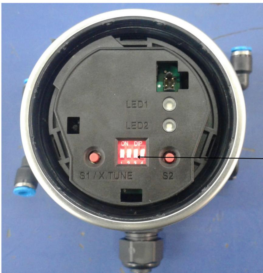
Si el dipswitch N°4 esta en la posición 0 la válvula se encuentra en estado automático.
